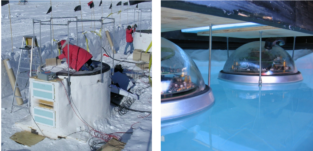
Figuur 1.8: IceTop tank zoals deze er uitziet bij installatie (links) en DOMs op het wateroppervlak in de tank net na vulling (rechts) [16].
